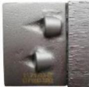
2 PKD-Segmente mit 1 Block-Stützsegment.
